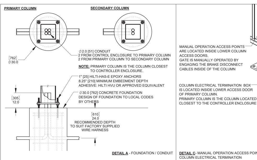
MANUAL OPERATION ACCESS POINTS ARE LOCATED INSIDE LOWER COLUMN ACCESS DOORS. GATE IS MANUALLY OPERATED BY ENGAGING THE BRAKE DISCONNECT CABLES INSIDE OF THE COLUMN
